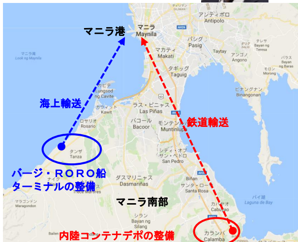
図：マニラ港へのアクセス改善計画 出所：Googleマップより筆者作成
