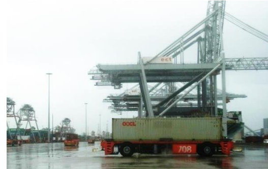
図：コンテナの搬送を行うAGV
