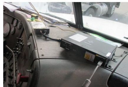
写真：トラックに設置されたデジタコ（ベトナム）
